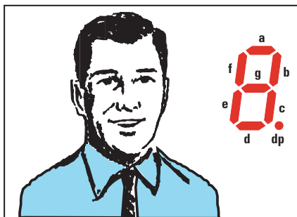
Figure 115 : On trouve, à l'intérieur d'un afficheur, 7 diodes LED en forme de segment. La disposition de chaque segment est indiquée par une lettre minuscule.
