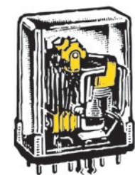
Figure 210 : Les relais peuvent avoir différentes formes et dimensions. Vous ne devez appliquer sur la bobine de chaque relais que la tension de travail pour laquelle elle a été calculée, c’est-à-dire 4, 6, 12, 24 et 48 volts.
